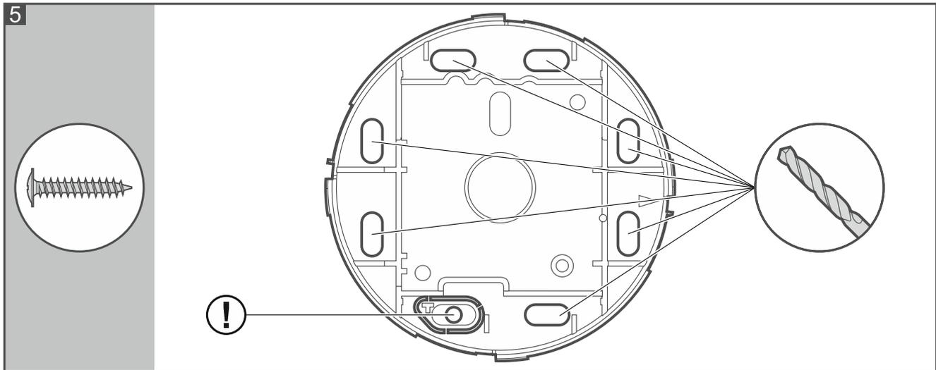
10. С помощью шурупов закрепите основание корпуса на монтажной поверхности. Если необходимо использовать дюбели, подберите их соответственно типу поверхности (одни – для бетона или кирпича, другие – для гипса, и т. д.).
