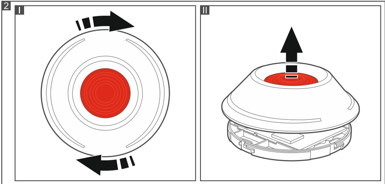
3. Закройте корпус кнопки. Обозначения, находящиеся на основании и крышке корпуса, облегчают закрытие (рис. 3).
